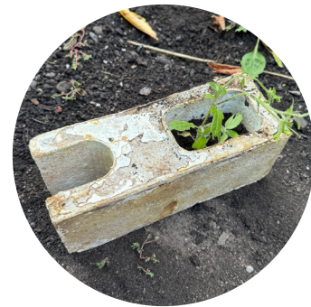
Brique de mycelium Réalisation prototype
