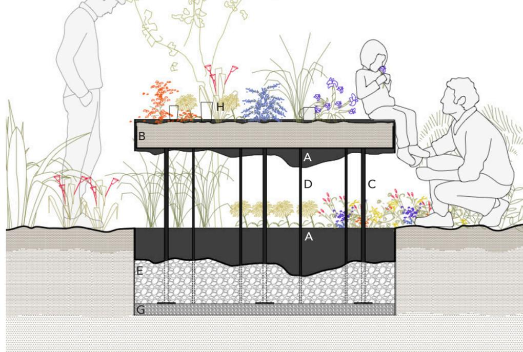
\*Les assemblages sont réfléchis de manière à faciliter la déconstruction. Une fois démantelés, les éléments d'acier pourront être recyclés et les plantes remises en terre sur place ou distribuées aux visiteurs.
