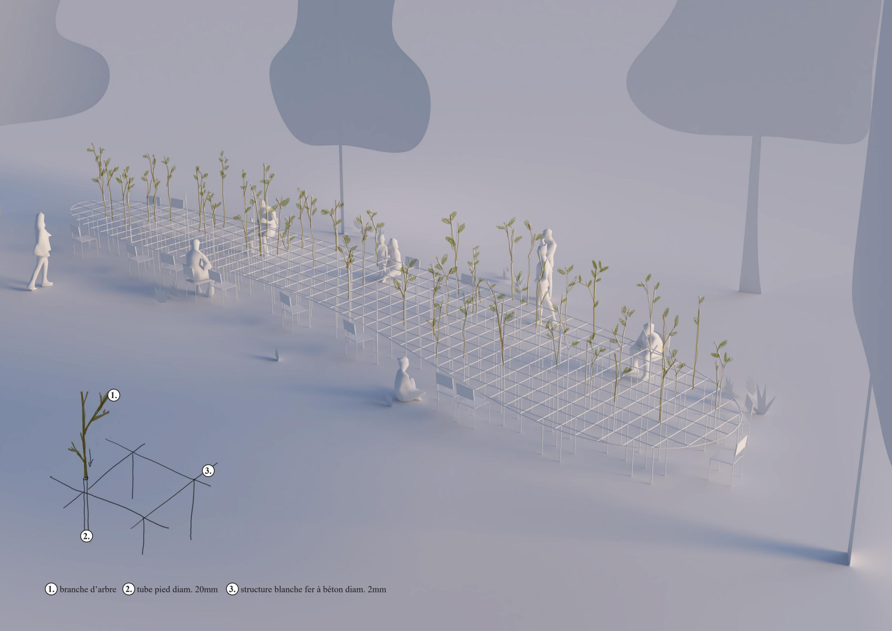
①. branche d'arbre ②. tube pied diam. 20mm ③. structure blanche fer à béton diam. 2mm
